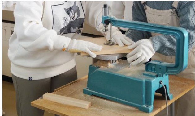
写真2 振動を押さえながらの加工
