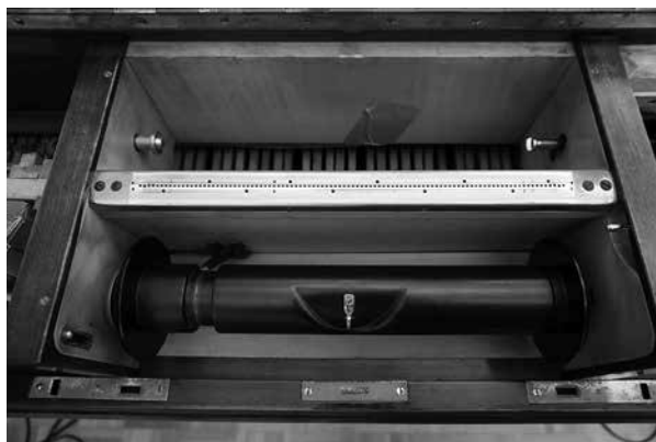
【図6】自動演奏ピアノのロールの読み取り部分（トラッカーバー）
