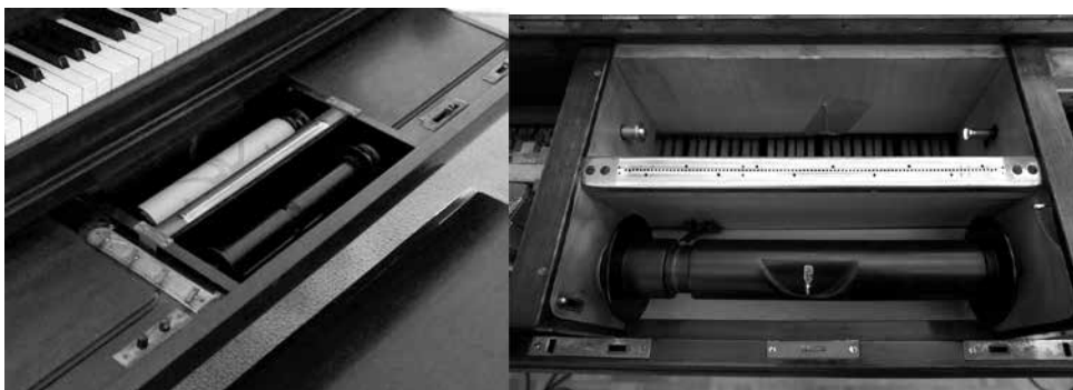
【写真9】手前から順に巻軸（take-up spool）、トラッカー・バー、ピアノロールの差し込み口
