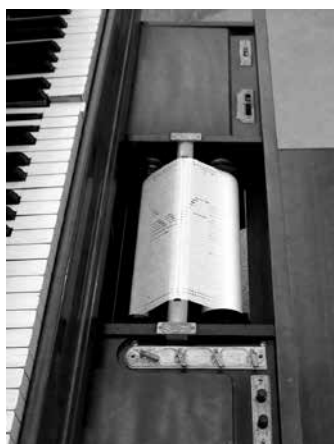
【写真10】演奏が進行するにつれて右側の巻軸側の半径が大きくなる
