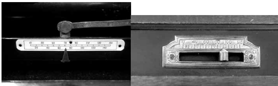
【写真2】自動演奏ピアノの速度調節つまみ
